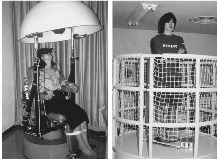
図3 コリオリ刺激実験風景. CCDビデオカメラによる眼球運動記録(左), 回転起立台上の圧中心移動記録(右).
